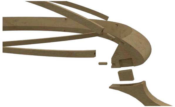
**Figg. 59a-b** - Esploso del risonatore acustico centrale. Sistema ottimizzato per le basse frequenze e relativo grafico di alfa.
