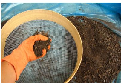
Figura 11 - Setacciatura del materiale a fine processo
