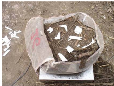
FASE 5. Riempimento dei sacchi con la Miscela Standard e i prodotti da testare
