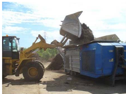
FASE 1. Introduzione nel trituratore della biomassa
