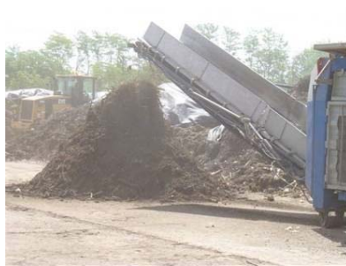
FASE 2. Triturazione e omogeneizzazione della biomassa
