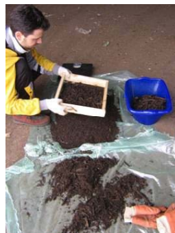
FASE 9. Vagliatura finale, ricognizione frammenti del manufatto e pesatura
