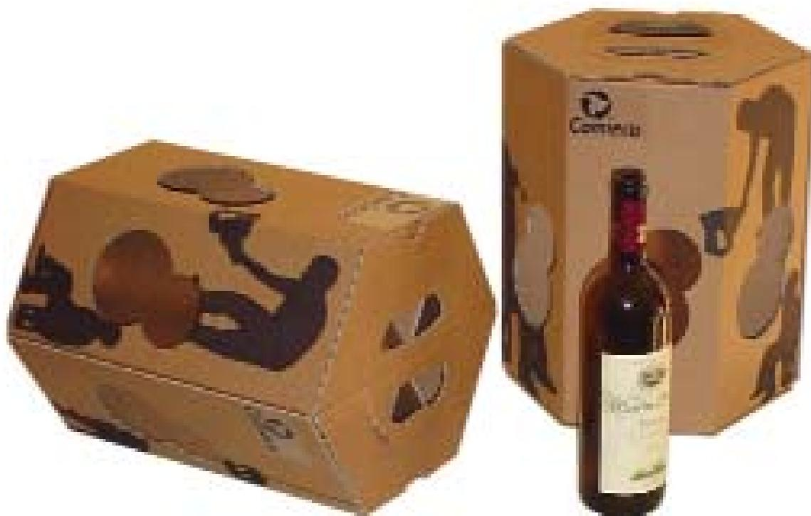
Alveino è un packaging per 6 bottiglie di vino biologico, realizzato in cartone ondulato doppia onda BE, spessore max. 4-5 mm., attraverso fustellature, cordonature e incastri, con un solo punto di colla. Molto resistente, facilmente abbattibile e totalmente riciclabile, la sua principale caratteristica è la riduzione del materiale impiegato, in quanto è contemporaneamente imballaggio secondario e terziario ed è progetta-
